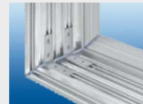
Die Alu-Profile vom Gehäuse ALU-DISPLAYPAC werden auf Gehrung gesägt und mit massiven Aluwinkel verschraubt, bei H = 100 mm mit zwei Winkel.
